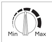
щью ручки, расположенной на внутренней стороне светофильтра. Короткая задержка подходит для точечной сварки, длинная задержка для сварки с большой силой тока.
